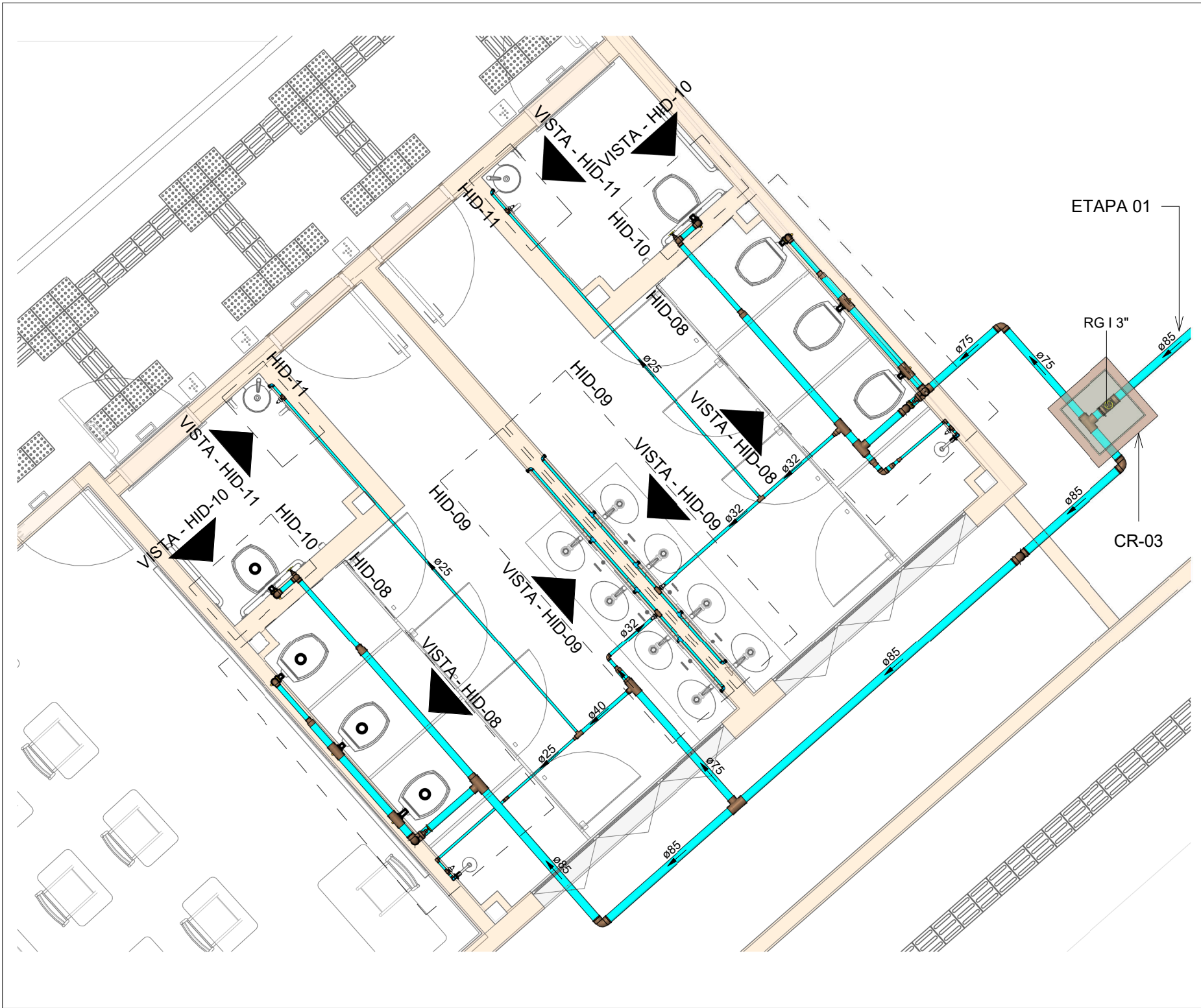
PLANTA BAIXA ÁGUA FRIA - TÉRREO (ETAPA 03/ PARTE 01) Escala 1 : 50
